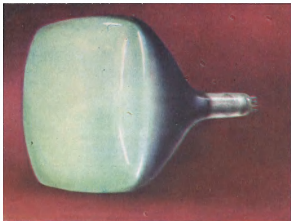
IV. Телевизионная электронно-лучевая трубка — кинескоп.
