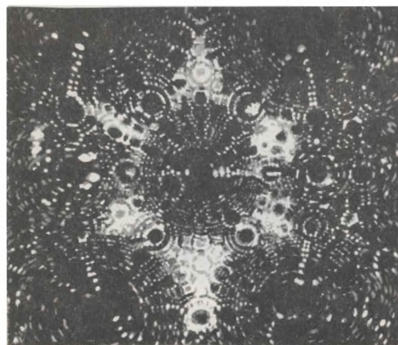
Изображение структуры кристалла вольфрама, полученное с помощью ионного микроскопа.
